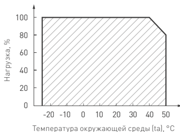
Рис. 2. Максимальная допустимая нагрузка, % от мощности источника.
